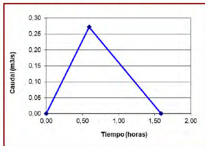
Hidrograma triangular del S.C.S. para la plataforma inferior
