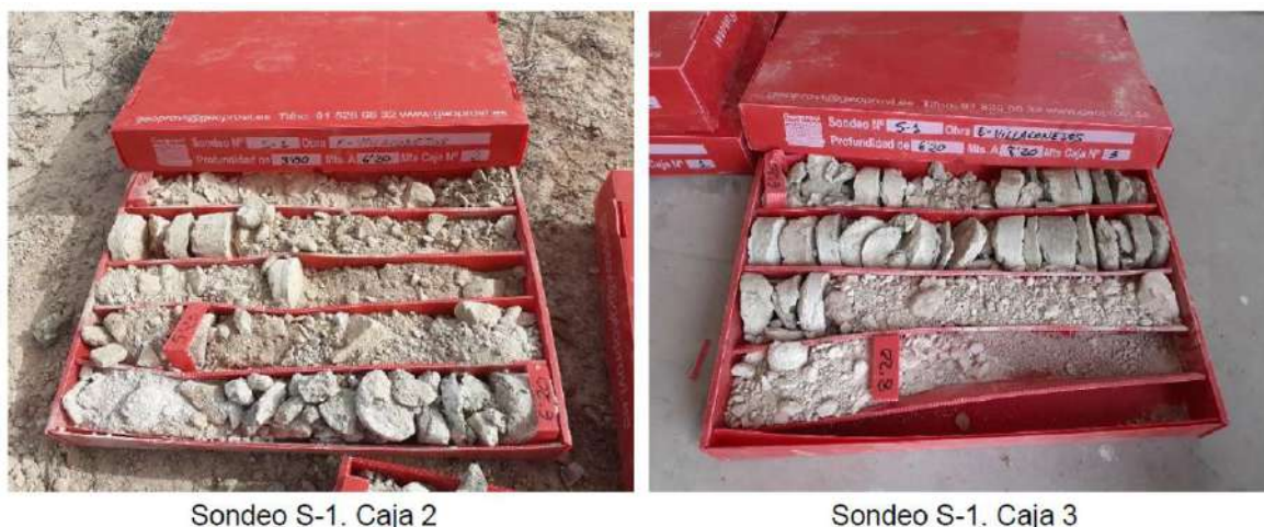
Figura 11. Cajas portatestigo del sondeo S1 de 3 a 8,20 m en las que se nota el carácter cohesivo y seco de las margas yesíferas arcillosas de la zona
