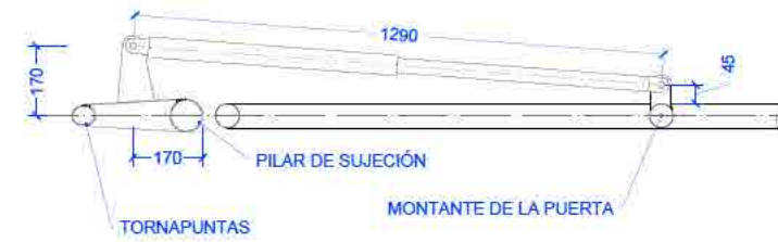
SISTEMA ELECTROMECÁNICO PARA APERTURA AUTOMATIZADA COTAS EN mm. Escala 1 / 20.
