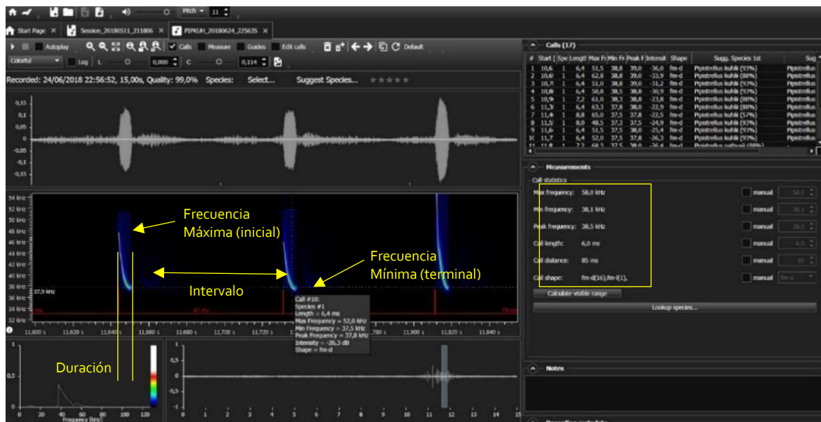
Figura 2.3.6.a. Representación de pulsos de murciélago de borde claro ( Pipistrellus kuhlii ). Fuente: Datos propios en el software BatExplorer 2.0. de Elekon AG.
