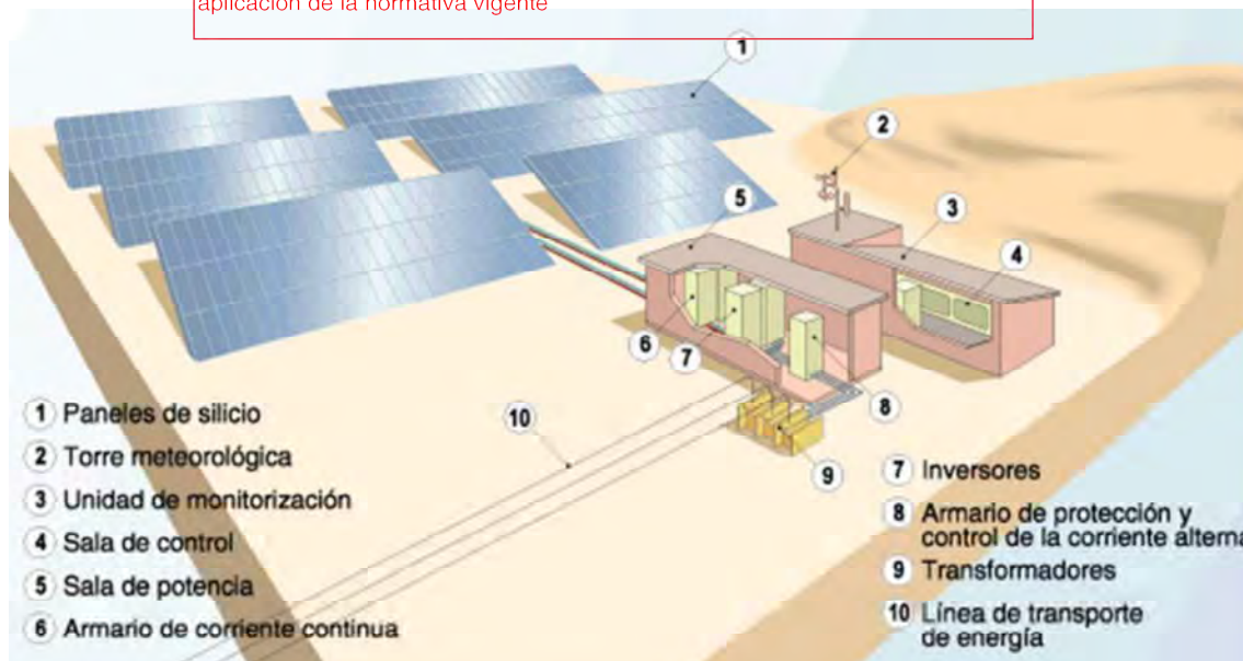
Imagen 1. Funcionamiento típico - genérico de una Planta Fotovoltaica
