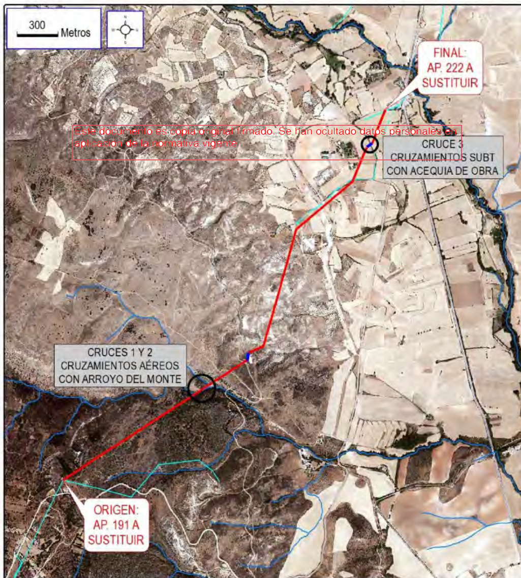
CROQUIS CRUZAMIENTOS CON CHT Elaborado por HG sobre ORTOFOTO: IDEM Comunidad de Madrid sobre y PNOA cedido por © IGN».
