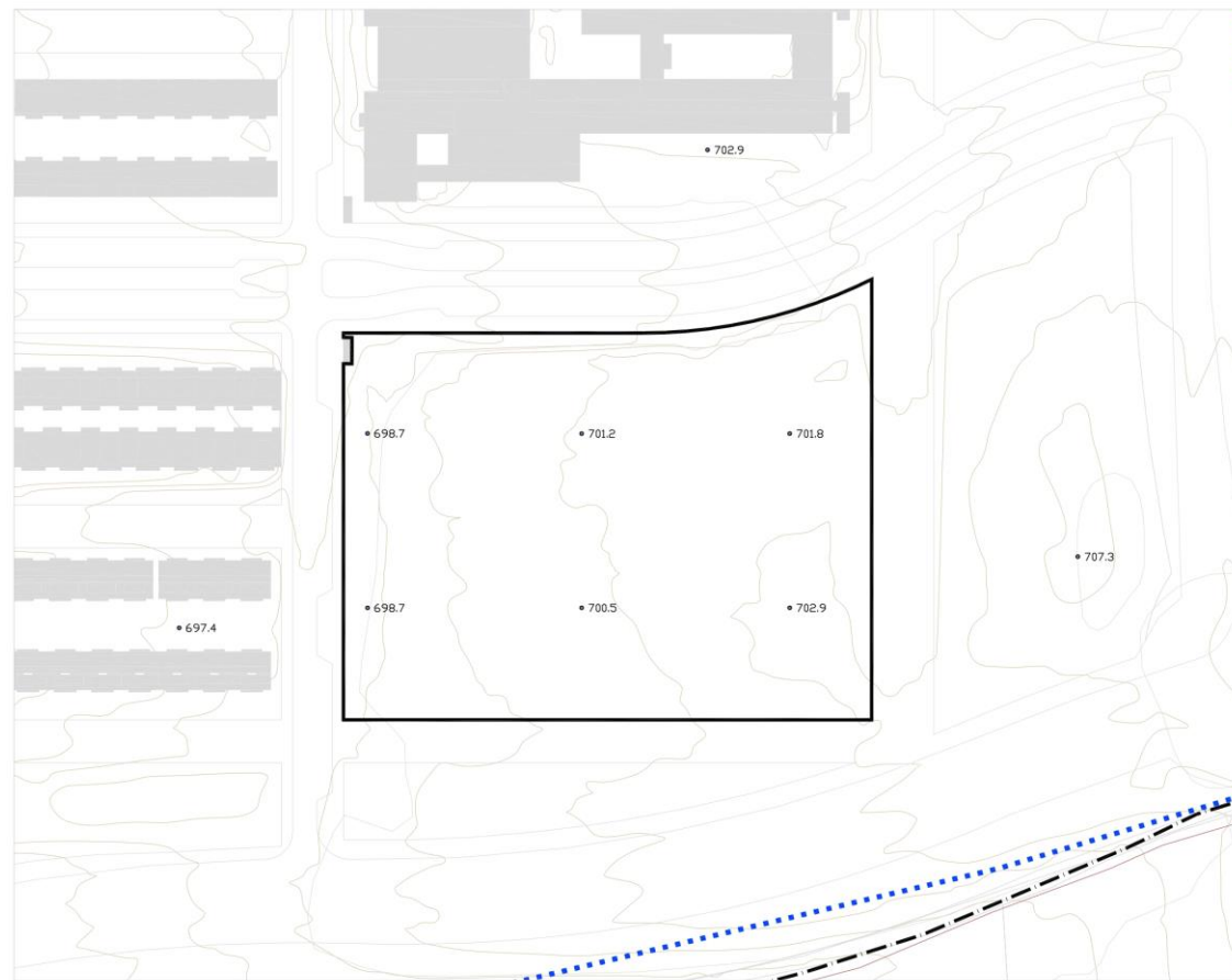
Figura 7. Levantamiento topográfico. Fuente: elaboración propia
