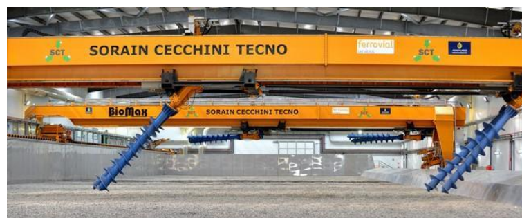
Ilustración 11. Compostaje en reactor con eje horizontal [Fuente: Sorain Cecchini]
