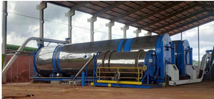
Ilustración 12. Tambor rotativo de compostaje [Fuente: Compost Turner]
