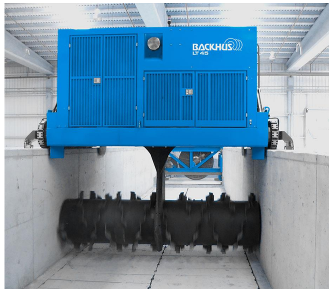
Ilustración 10. Trinchera con equipo volteador [Fuente: Eggersmann]
