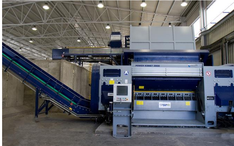
Ilustración 15. Triturador secundario para fabricación de CDR [Fuente: Grupo SPR]
