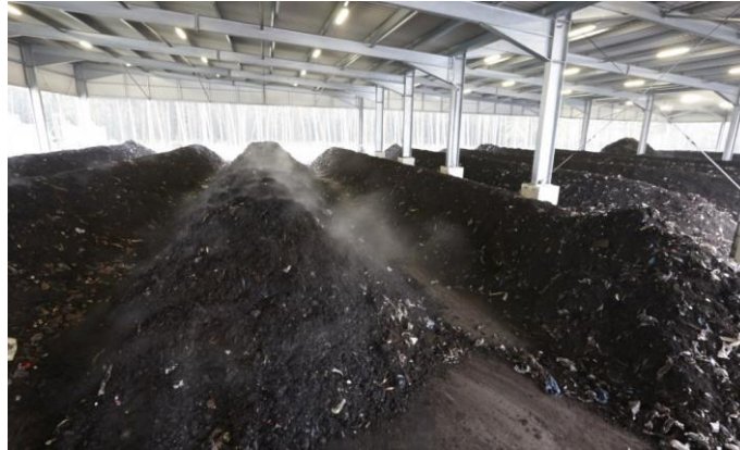
Ilustración 8. Pilas estáticas con aireación pasiva [Fuente: Imágenes archivo GRUPOTEC]
