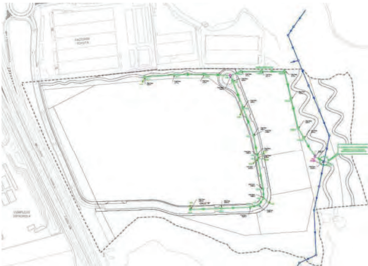
Figura 19: Vertido de la red de pluviales en el río Guadalix
