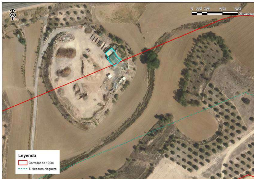
Figura 22. Edificación nº 6 sobre ortofoto en la que se observa un corredor de 100 m de anchura (línea roja continua) a cada lado del eje del tramo de línea Henares-Noguera (línea verde discontinua).
