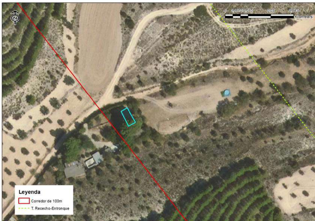
Figura 37. Edificación nº 11 sobre ortofoto en la que se observa un corredor de 100 m de anchura (línea roja continua) a cada lado del eje del tramo de líneas Rececho-Entronque (línea verde discontinua).
