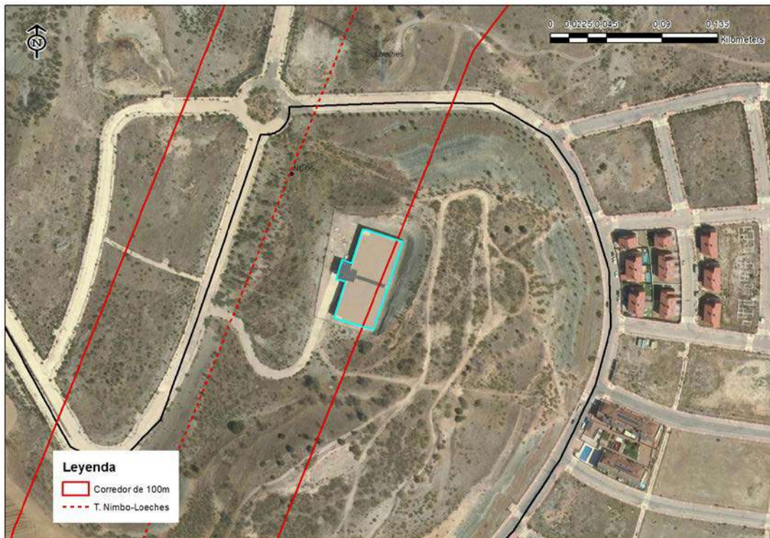
Figura 31. Edificación nº 9 sobre ortofoto en la que se observa un corredor de 100 m de anchura (línea roja continua) a cada lado del eje del tramo de líneas Nimbo-SE Loeches (línea roja discontinua).
