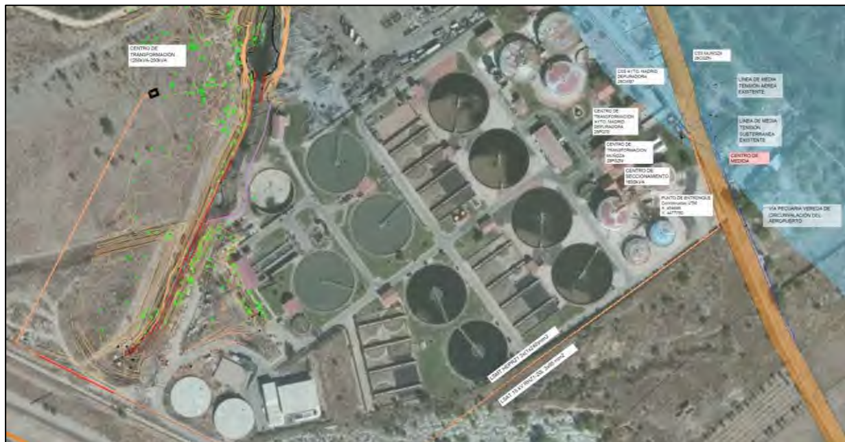
Ilustración 20. Acometida eléctrica y trazado para suministro a tuneladora
