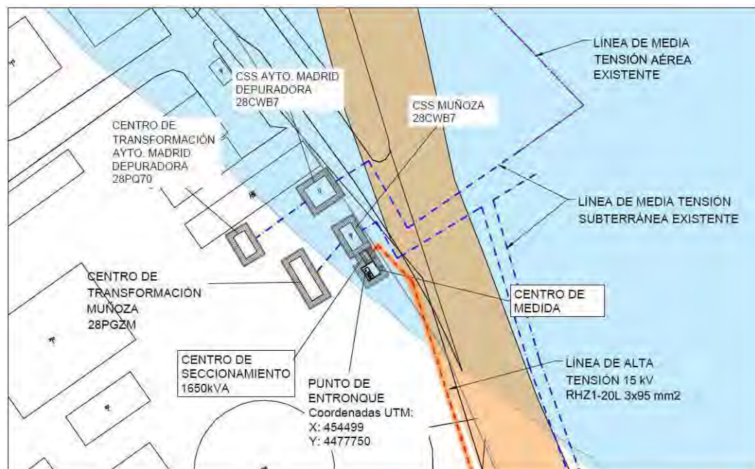
Ilustración 21. Detalle de acometida eléctrica y punto de entronque con la línea de alta tensión existente
