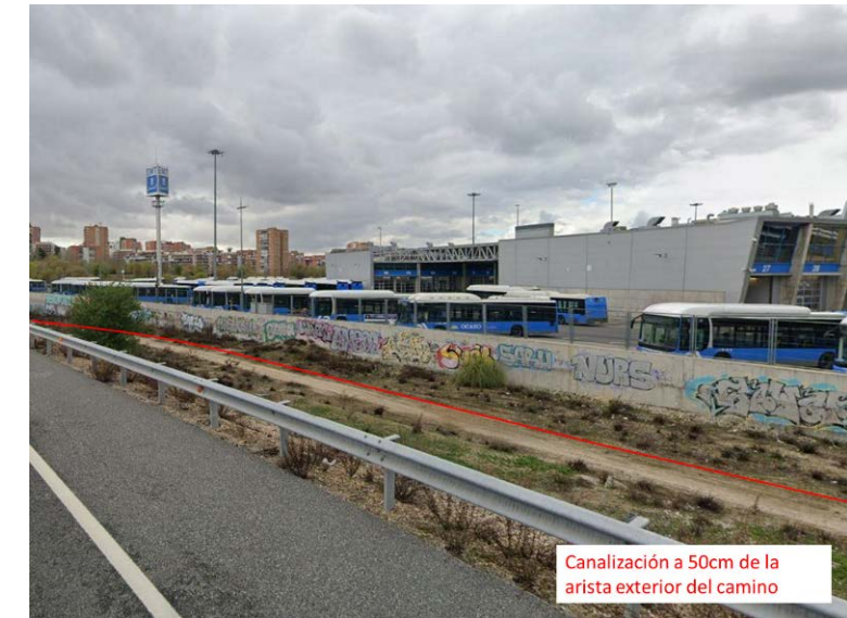
Figura 5: Canalización junto a camino existente junto al centro de operaciones de EMT en Sanchinarro
