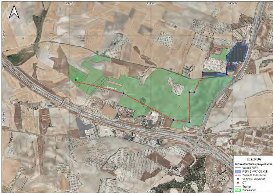
Figura 10. Ubicación de las líneas subterráneas de media tensión en la planta “Envatios XXIII”
