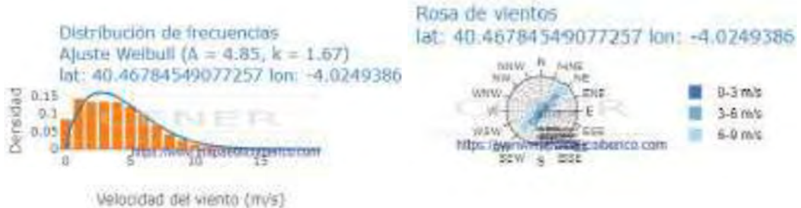
Imagen 14. Rosa de los vientos e histograma de velocidades. Fuente: Centro Nacional de Energías Renovables (CENER).
