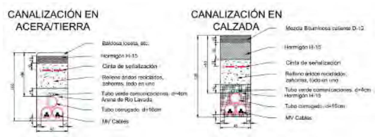
Imagen 8. Secciones tipo zanja interconexión
