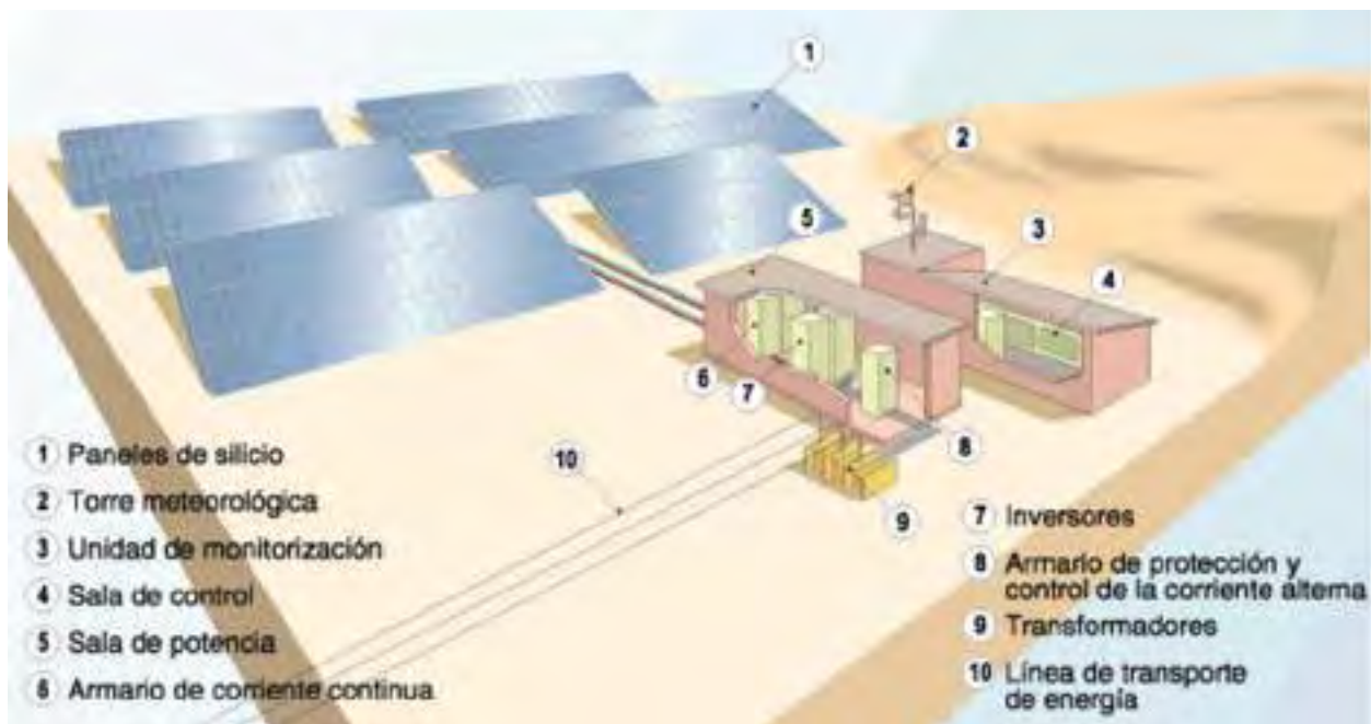
Imagen 1. Funcionamiento tipo - genérico de una Planta Fotovoltaica
