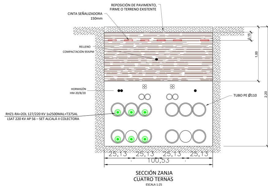
DETALLE SECCIÓN TRANSVERSAL. ESCALA: S/E
