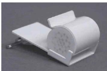
Figura 1. Captador pasivo Ogawa. (Fuente: Manual Radiello).
