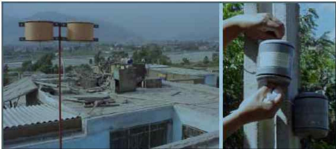
Figura 5. Contenedor especial de protección de los tubos captadores.
