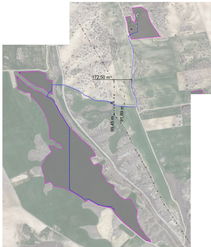
Figura 10. Cruzamiento de la línea de AT con la zanja de MT
